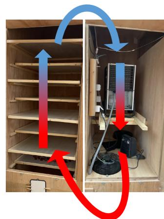
FIGURE 34. Circulation de l'air dans un séchoir avec ventilateur et déshumidificateur : en rouge, l'air sec et en bleu, l'air humidifié.
