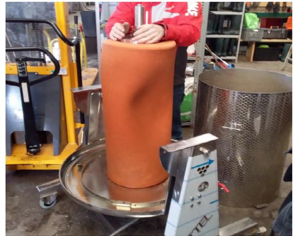
*Si la presse à corbeille et la presse à paquet conviennent mieux pour les pomme et poires, l'hydropresse est la plus polyvalente car elle permet de presser à la fois les pommes et poires mais également les petits fruits (fraises, framboises, etc.). De plus, elle ne nécessite pas d'électricité. Cela en fait la meilleure presse pour débuter une activité. »*
