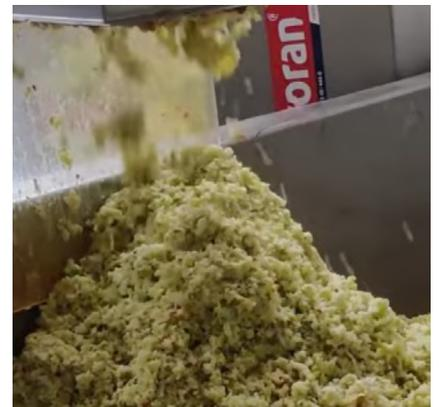
**FIGURE 4.** Réduction de taille : à gauche, la texture est utilisable en mousseline mais pas pour du jus - à droite, le broyat est pressable pour en extraire le jus car les fibres restent séparées du liquide.
