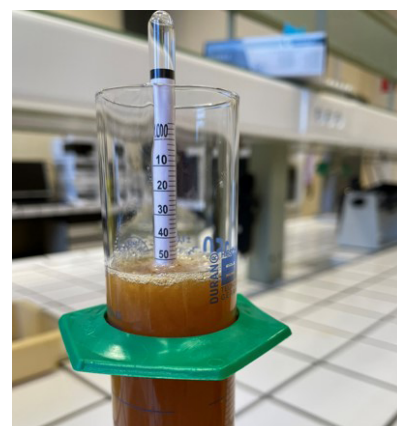
FIGURE 1. Lecture d'un moût à 1055 points de densité (à 25^\circ C ).
